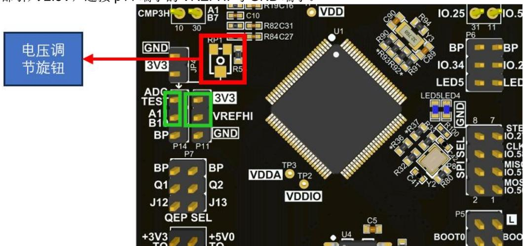
图 2-11-1 ADC 测试引脚 PCB 示意图
