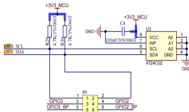
图 2-5-2 I2C 引脚硬件原理图
