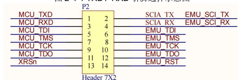
图 2-4-2 TXD、RXD 与调试引脚硬件原理图
