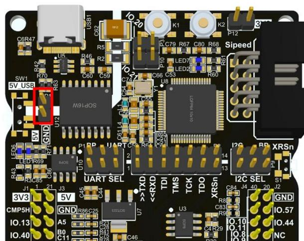
图 2-2-1 JP1 PCB 管脚示意图
