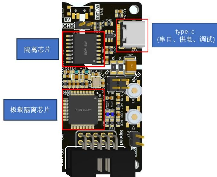
图 2-1-1 板载调试与隔离电路示意图
