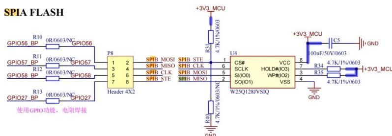
图 2-8-2 SPI 硬件原理示意图
