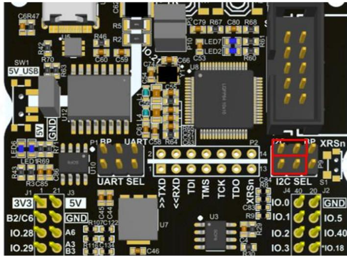
图 2-5-3 I2C SEL 引脚选择示意图
