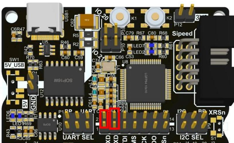
图 2-4-1 TXD、RXD 引脚选择示意图
