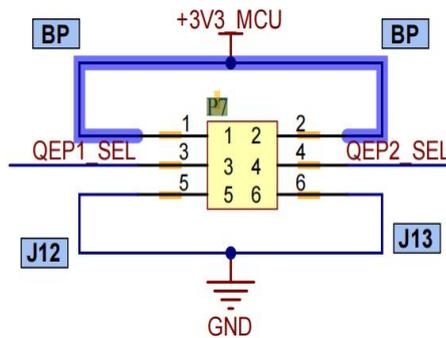
图 2-9-2 QEPSEL 硬件原理示意图
