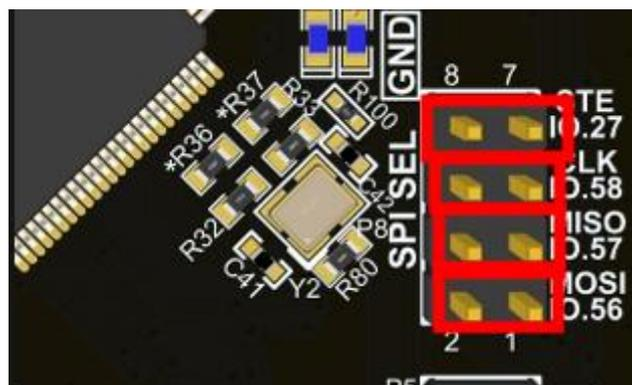
图 2-8-1 SPI PCB 硬件管脚连接
