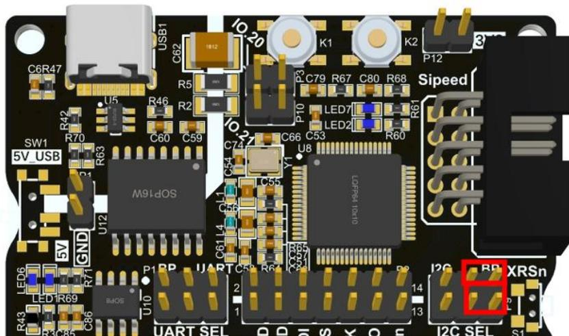
图 2-5-1 I2C BP 引脚选择示意图
