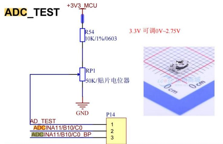
图 2-11-2 ADC 测试引脚硬件示意图
